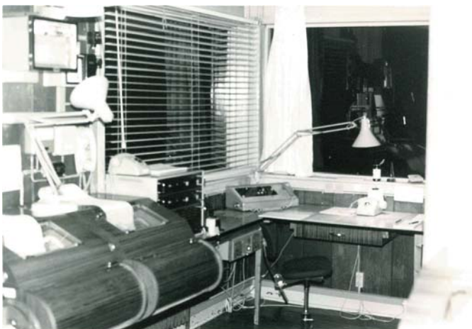
Arbejdspositionen i AFIS. Yderst t.v. AFTN-linien til Com Centre i Sdr. Strømfjord. T.h. for denne Flylog Omnibus hvor telegrafisterne på Julianehåb Radio skrev deres kommunikation med flyene. Under bordet monitor til flyvepladsen radiofy. Over denne det vigtige arbejdsredskab blyantspidseren
